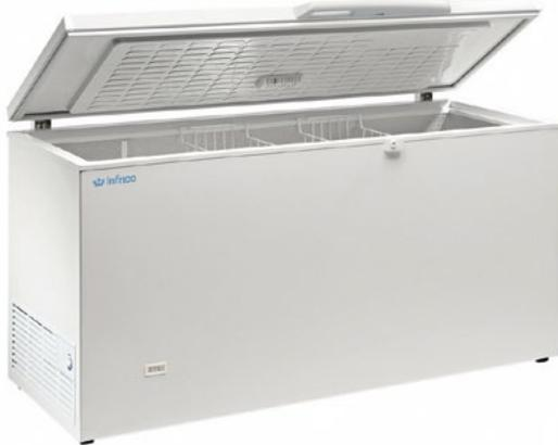
Cuve intérieure en aluminium (Mod. ) ou en acier inoxydable.(Mod. I). Isolation en polyuréthane injecté à haute pression (100% libre de CFC'S), avec 70 mm d'épaisseur, sauf le mod. CH550 avec épaisseur 55 mm et mod. HF 700 avec épaisseur 60 mm. Thermomètre analogique, thermostat réglable avec la possibilité de congélation rapide. Couvercle battant avec serrure à clé. Lumière intérieure. Réfrigérant HC R600 a et R-290.
